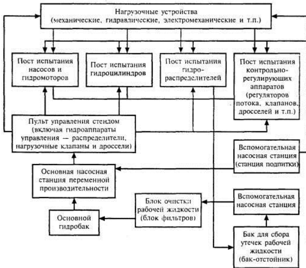
Рисунок 1 - Блок-схема универсального стенда для диагностирования гидропривода машин
