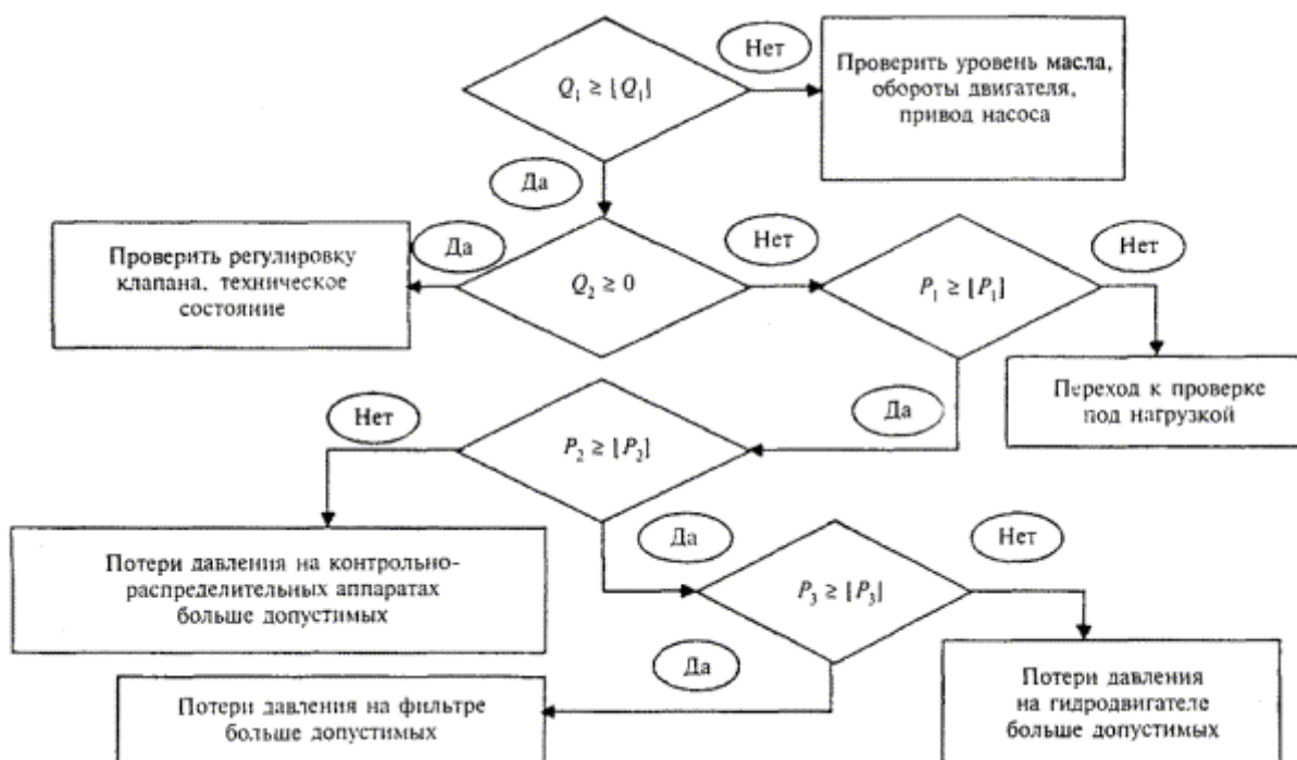
Рисунок 5 - Алгоритм диагностирования гидропривода в режиме холостого хода
