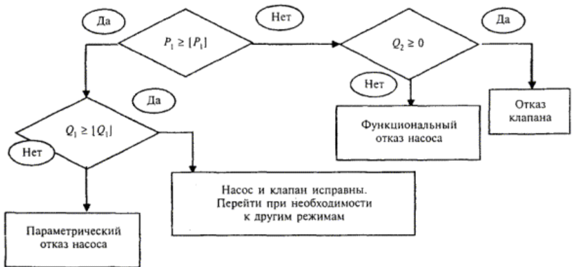
Рисунок 6 - Алгоритм диагностирования гидросистемы в клапанном режиме
