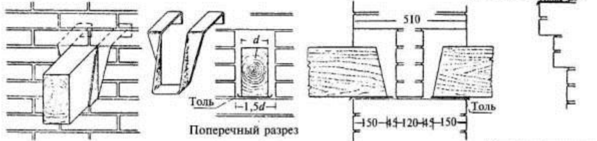
Укладка балок на кирпичную консоль
