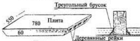
Накат из гипсо-реечных плит
