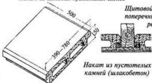
Накат из гипсовых пустотелых блоков
