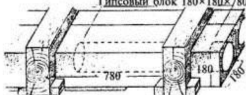
Накат из гипсовых пустотелых блоков
