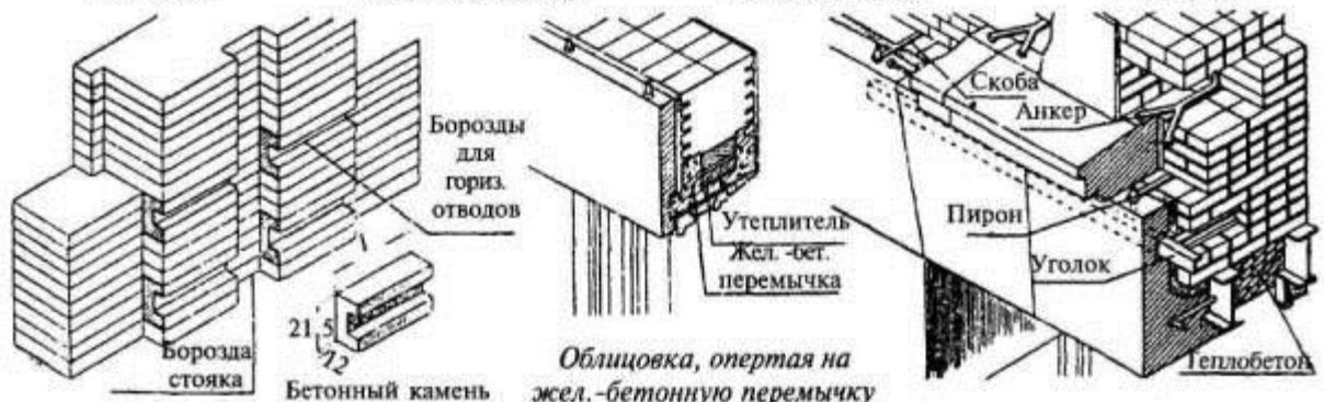
Облицовка перемычки, опертая на профильное железо
