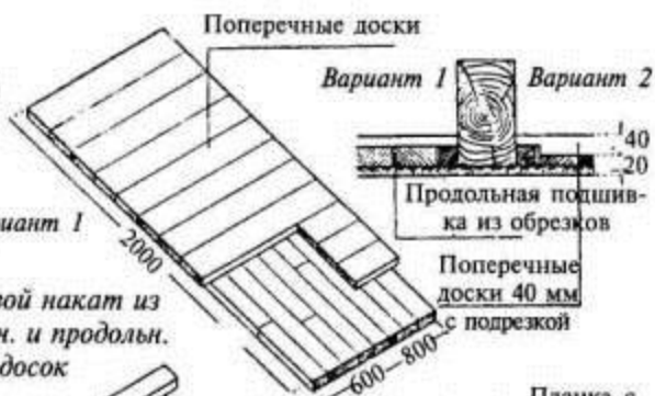
Щитовой накат из продольных пластин или горбылей
