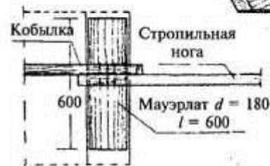
Опираие дощатой стропильной ноги на мауэрлат
